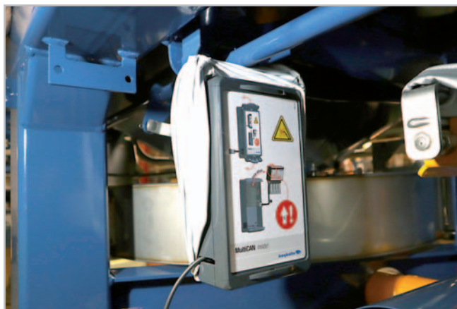
Multican box dokonale ochrání veškerou elektroniku na stroji Foto archiv firmy
