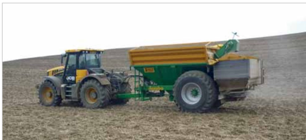
Zásobní hnojení je příležitost k využití velkoobjemových řešení. Na fotografii kombinace překládacího vozu Perrein Jumbo 9000 a rozmetadla Bogballe M3W s automatickou kalibrací Foto archiv firmy
