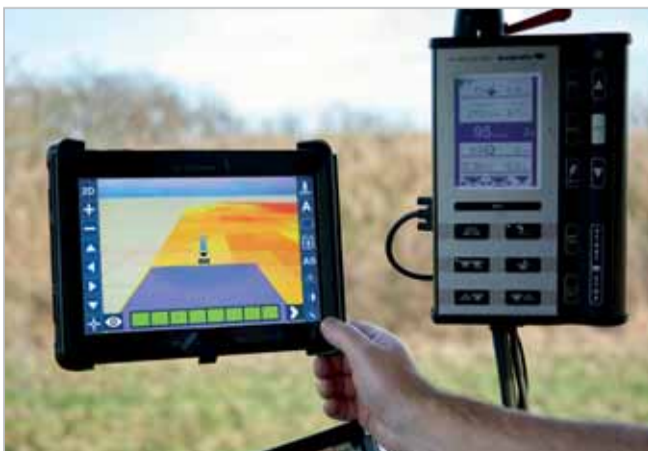
NaviCOM je řešení navigace rozmetadla přímo od Bogballe. Jeho instalace na jakýkoliv traktor netrvá déle než půl hodiny a přístroj kompletně ovládá všechny vyspělé funkce rozmetadla. Nahrát do něj přitom klidně můžete zásobu aplikačních map pro celý podnik. Pokud je stroj vybaven ovládáním sekcí SCD, umí funkce DualDynamic podle pokynů aplikační mapy zajistit i různé dávky v rámci záběru rozmetadla Foto archiv firmy
