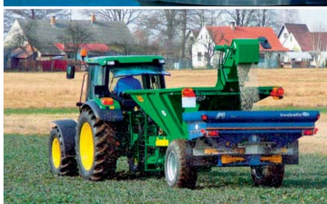
Po Terragatorech bylo Bogballe prvním „malým“ rozmetadlem které v ČR variabilně hnojilo v rámci systému PREFARM Foto archiv firmy
