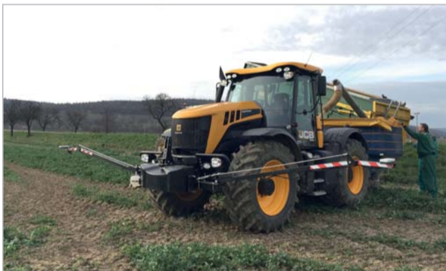
Plodinová čidla OptRx – hydraulicky sklopná ramena umožňují běžné pracovní rychlosti Foto archiv firmy
