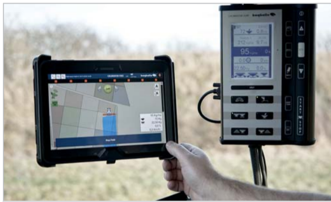
Variabilní aplikace (VRA) od letoška fungují u Bogballe i na tabletech – aplikace CALIBRATOR FREE Foto archiv firmy
