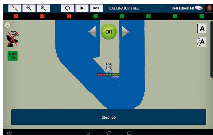
Záběr rozmetadla je na obrazovce zobrazen jako osm nezávislých sekčí Foto archiv firmy
