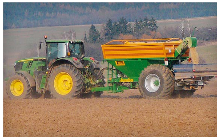
Doplňování hnojiva z devítitunového vozu Perrein Jumbo probíhá za plného provozu rozmetadla Foto archiv firmy
